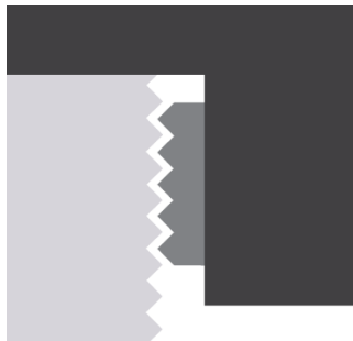
Mehrstufig einstellbare Gleitbacke
