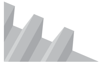
Schraube mit Trapezgewinde: Mehr Klemmkraft bei weniger Betätigungskraft.
