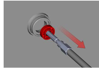
Das Lager wird nach einigen Schlägen schnell und einfach ohne Beschädigungen aus dem Gehäuse geschlagen.
