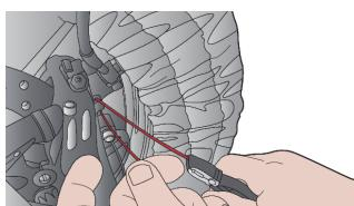
Χρησιμοποιήστε την πένσα περιστροφής του σύρματος ασφαλείας για να πιάσετε τα δύο σύρματα σε κατάλληλη απόσταση από το σύνδεσμο. Το μήκος των άκρων του σύρματος μεταξύ της πένσας και του συνδέσμου θα περιστραφεί στο επόμενο βήμα.
