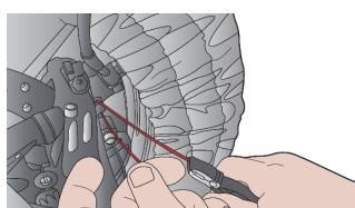
Използвайте клещите за усукване на предпазен проводник, за да хванете двата проводника на подходящо разстояние от закопчалката. Дължината на проводниците между клещите и закопчалката ще бъде усукана в следващата стъпка.
