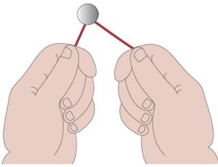
Führen Sie den Sicherheitsdraht in geeigneter Weise durch Ihr(e) Befestigungselement(e). Sie haben jetzt zwei Enden des Drahtes zum Verdrehen bereit.
