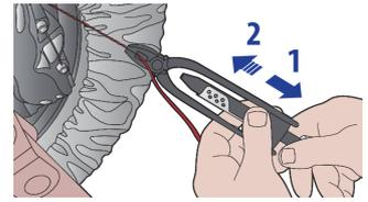
Lassen Sie die Zangengriffe los und ziehen Sie am Chromgriff an der Basis der Zange, um die Zange zu drehen und den Draht im Uhrzeigersinn zu verdrillen.
