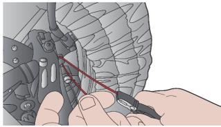
Greifen Sie mit der Sicherheitsdrahtzange die beiden Drähte in einem angemessenen Abstand zum Befestigungselement. Die Drahtlänge zwischen der Zange und dem Befestigungselement wird im folgenden Schritt verdrillt.
