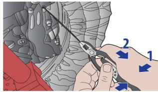
Schieben Sie die zentrale verchromte Verriegelungshülse, um die Zangengriffe miteinander zu verriegeln und die Drahtenden zu klemmen.
