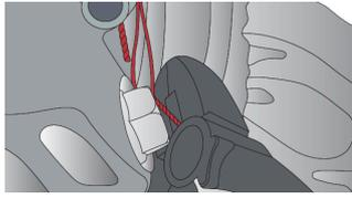
Drücken Sie die Zangengriffe zusammen, um den verchromten Verriegelungsschieber zu lösen, und verwenden Sie dann den integrierten Drahtschneider, um die Drähte auf Länge zu kürzen.
