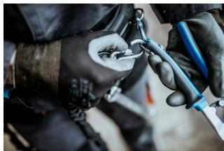
Pričvrstite karabiner na remenu za vezivanje na kopču alata. Kopče su dovoljno velike da drže 2 karabinera.
