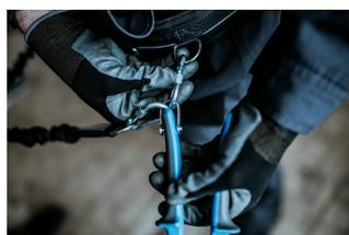
Před vyjmutím nástroje z pásu odšroubujte pojistný kroužek na karabině na pásu.
