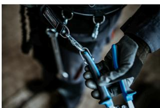
Správně upevněte nástroje na lanku. Vraťte nástroj k pásu podle kroků v opačném pořadí.
