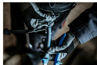
Откройте карабин на поясе и снимите с него инструмент с прикрепленной к нему стропой. Инструмент готов к использованию.
