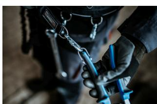
Slika prikazuje pravilno kačenje alata za vezni element. Okačite alat za pojas, idući koracima u obrtnutom redosledu.
