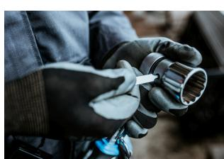
Используя ключ для смены торцевых головок (арт. 1111), вдавите штифт в отверстие, одновременно снимая головку с приводного квадрата трещотки, после чего установите другую головку или удлинитель.
