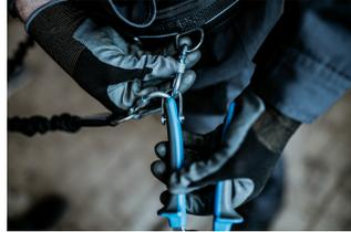
Vor Abnehmen des Werkzeuges vom Gürtel ist die Schraubsicherung am Karabiner am Gürtel zu öffnen.
