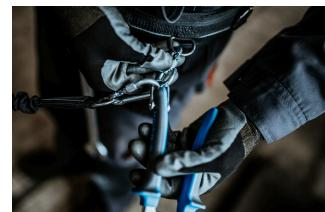
Откройте карабин на пояске и снимите с него инструмент с прикрепленной к нему стропой. Инструмент готов к использованию.
