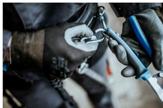
Карабинерът на ремъка е прикрепен към пръстена на инструмента. Пръстените на инструментите са достатъчно големи, за да приемат 2 карабини.
