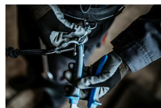
Otkopčajte karabiner na remenu i uklonite alat pričvršćen za uzicu. Alat je sada spreman za rad.
