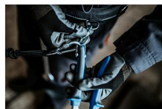
Ouvrir le mousqueton de la ceinture et sortir l'outil qui est attaché à la lanière, du mousqueton de la ceinture. L'outil est maintenant prêt à l'usage.
