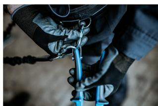
Avant de retirer l'outil de la ceinture, devissier l'écrou de sécurité du mousqueton de la ceinture.
