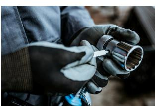
Pritisnite iglu u rupu s alatom za rastavljanje nasadnog ključa (stavka 1111), te istovremeno uklonite nasadni ključ sa račne i zamijenite nasadni ključ ili nastavak.
