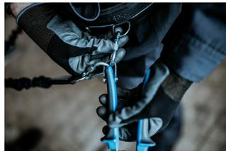
Avant de retirer l'outil de la ceinture, dévisser l'écrou de sécurité du mousqueton de la ceinture.
