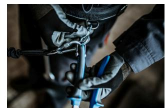
Откройте карабин на пояске и снимите с него инструмент с прикрепленной к нему стропой.
