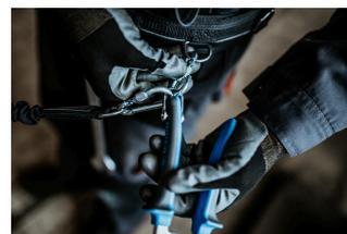
Откройте карбин на поясе и снимите с него инструмент с прикрепленной к нему стропой. Инструмент готов к использованию.
