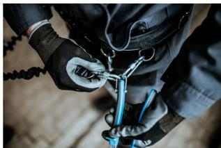
Der Karabiner am Umhängeband ist mit Schraubverschluss gegen Öffnen zu sichern.
