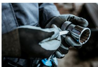
Koristeći se izbjiačem nasadnih ključeva (art. 1111) pritisnite pin u rupi i skinite ključ sa čegrtaljke, a zatim stavite drugi ključ ili produžetak.
