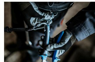
Откройте карабин на пояссе и снимите с него инструмент с прикрепленной к нему стропой.
