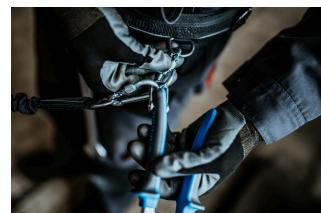
Otkopčajte karabiner na remenu i uklonite alat pričvršćen za uzicu. Alat je sada spremam za rad.
