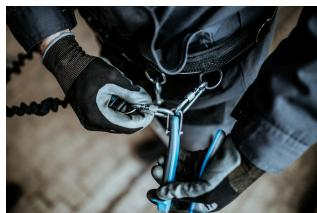
Карабинерът на ремъка трябва да бъде защищен срещу отваряне с помощта на заключващ пръстен.
