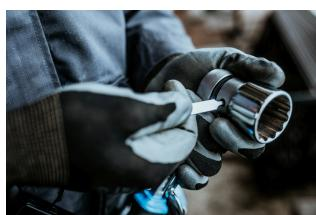
Pomocou odstraňovača zásuviek (produkt 1111) stlačte kolík v otvore, pričom vyberte zásuvku zo štvorcového pohoru račne a potom zásuvku alebo predĺženie prepnite.
