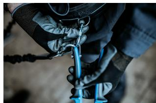
Prije skidanja alata s remena, odvignite maticu na karabineru.
