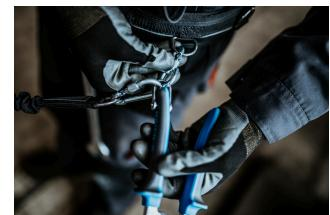
Otkopčajte karabiner na remenu i uklonite alat pričvršćen za užicu. Alat je sada spreman za rad.
