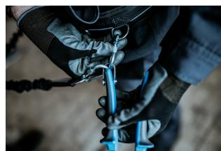
Prije skidanja alata s remena, odvrnite maticu na karabineru.
