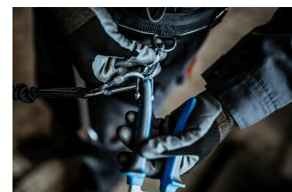
Otkopčajte karabiner na remenu i uklonite alat pričvršćen za uzicu. Alat je sada spremjan za rad.
