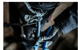
Otvorite karabinjer na pojusu i skinite alat sa karabinjera. Alat je sada spreman za upotrebu.
