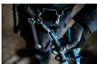
Slika prikazuje pravilno kačenje alata za vezni element. Okačite alat za pojus, idući koracima u obrnutom redosledu.
