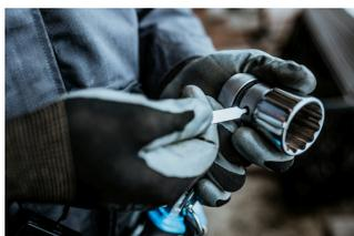
Используя ключ для смены торцевых головок (артикул 1111), вдавите штифт в отверстие, одновременно снимая головку с приводного квадрата трещотки, после чего установите другую головку или удлинитель.
