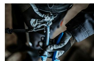
Otkopčajte karabiner na remenu i uklonite alat pričvršćen za užicu. Alat je sada spremjan za rad.
