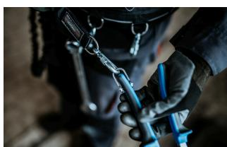
Slika prikazuje pravilno kačenje alata za vezni element. Okačite alat za pojus, idući koracima u obrnutom redosledu.
