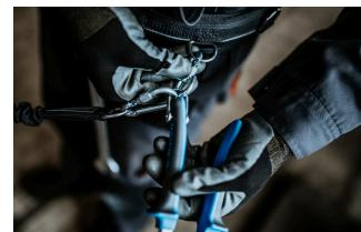
Otvorite karabinjer na pojusu i skinite alat sa karabinjera. Alat je sada spremam za upotrebu.
