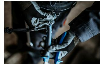
Otkopčajte karabiner na remenu i uklonite alat pričvršćen za uzicu. Alat je sada spremjan za rad.
