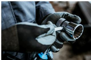
Koristeći se izbijačem nasadnih ključeva (art. 1111) pritisnite pin u rupi i skinite ključ sa čegrtaljke, a zatim stavite drugi ključ ili produžetak.
