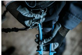
Avant de retirer l'outil de la ceinture, devisser l'écrou de sécurité du mousqueton de la ceinture.
