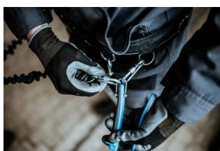
Карабинерът на ремъка трябва да бъде защитен срещу отваряне с помощта на заключващ пръстен.
