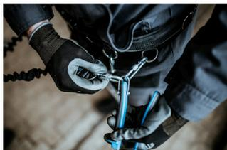
Le mousqueton sur la lanière doit être sécurisé contre toute ouverture accidentelle grâce à l'écrou de sécurité
