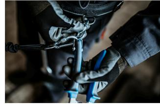
Den Karabiner am Gürtel öffnen und das am Umhängeband hängende Werkzeug vom Karabiner am Gürtel abnehmen. Das Werkzeug kann jetzt benutzt werden.
