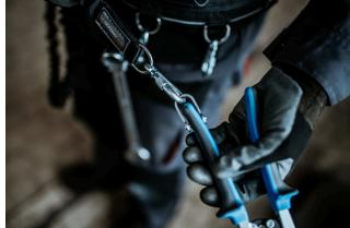
Slika prikazuje pravilno kačenje alata za vezni element. Okačite alat za pojas, idući koracima u obrnutom redosledu.
