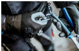
Pričvrstite karabiner na remenu za vezivanje na kopču alata. Kopče su dovoljno velike da drže 2 karabinera.
