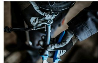
Ouvrir le mousqueton de la ceinture et sortir l'outil, attaché à la lanière, du mousqueton de la ceinture. L'outil est maintenant prêt à l'usage.
