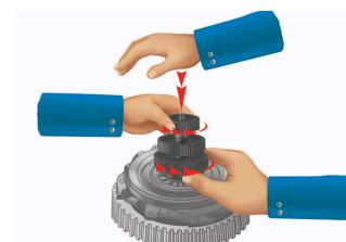
Postavite kvačilo na zamašnjak motora i fiksirajte ga. Odvrnute najmanji kotačić (3). Zatim potpuno odvrnute najveći kotač (1) i potisnite da oslobodite konusni dio. Uklonite alat s kvačila.
