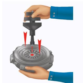
Oslobodite najveći kotačić (3) i okrećite ga dok ne dodirne drugi kotačić (2). Održavajući položaj regulacijskog vijka, odvrnute najmanji kotačić (1) i dovedite ga da se nasloni na kotačić (2). Postavite alat u centar lamele kroz korpu kvačila i pritisnite prema dolje.
