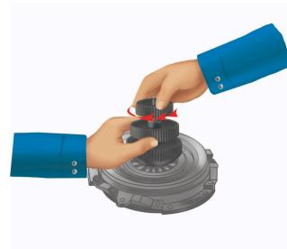
Fiksirajte položaj kotačića (2), i istovremeno okrećite najmanji kotačića (1) i sve dok se ne pričvrsti konusni dio alata u centru lamele
