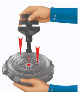
Γυρίστε τη ροδέλα (3) μέχρι να ακουμπήσει τη ροδέλα (2). Σταθεροποιήστε τη βίδα ρύθμισης, ξεβιδώστε τη ροδέλα (1) και στηρίξτε τη στη ροδέλα (2). Εισάγετε τη συσκευή στο κέντρο του δίσκου, να περνά από την πλάκα του ελάσματος και πιέστε κάτω.
