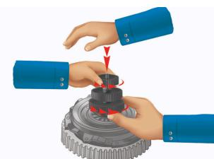
Τοποθετήστε και στερεώστε τον συμπλέκτη στο βολάν. Ξεβιδώστε τη ροδέλα (3). Ξεβιδώστε τελείως τη ροδέλα (1) και πιέστε για να απελευθερώσετε τον κώνο εξαγωγής. Αφαιρέστε το εργαλείο από τον συμπλέκτη.
