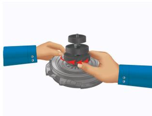
Achten Sie auf die Zentrierung der Kupplung und Schrauben Sie den Griff (3) in Richtung der Druckplatte.
