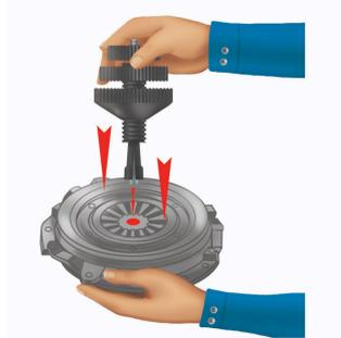
Drehen Sie den Griff (3), bis dieser den Griff (2) berührt. Schrauben Sie den Griff (1) ab bis zum Anschlag an den Griff (2) und bewegen Sie hierbei nicht die Stellschraube. Setzen Sie das Werkzeug durch die Druckplatte in die Mitte der Kupplung und drücken Sie es hinunter.
