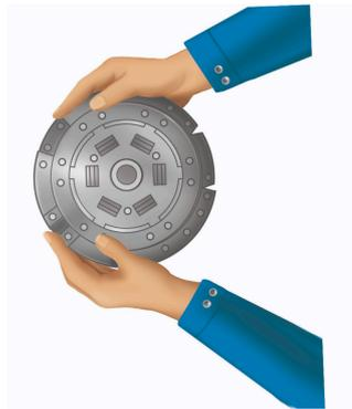
Zentrieren Sie die Kupplungsplatte mit der Hand zur Druckplatte.
