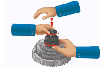
Setzen Sie die Kupplung an die Motorschwungscheibe. Lösen Sie den Griff (3). Schrauben Sie den Griff vollkommen ab und lösen Sie durch Drücken den Dehnkegel. Entfernen Sie das Werkzeug von der Kupplung.
