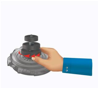
Schrauben Sie den Griff (3) zu bis zum Anschlag an die Druckplatte. Schrauben Sie den Griff nicht fest.
