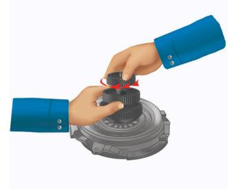
Halten Sie den Griff (2) und drehen Sie den Griff (1), bis der Ausdehnkegel nicht in der Mitte der Kupplung stehen bleibt.
