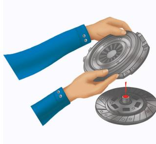
Setzen Sie die Druckplatte auf die Kupplungsscheibe.
