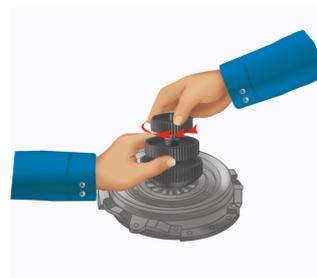
Tout en maintenant le bouton moleté (2) en place, tourner le bouton moleté (1) pour bloquer le cône expansible dans le centre du disque d'embrayage.
