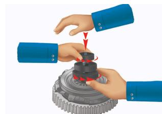
Positionner l'embrayage sur le volant moteur et le fixer solidement. Dévisser le bouton moleté (3). Dévisser complètement le bouton moleté (1) et appuyer pour libérer le cône expansible. Enlever l'outil de l'embrayage.
