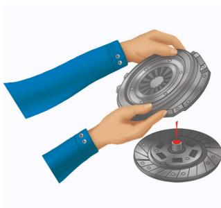
Positionner l'assiette ressort sur le disque d'embrayage.
