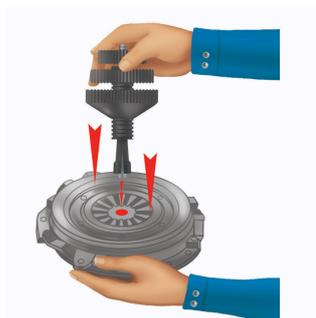
Tourner le bouton moleté (3) jusqu'à ce qu'il entre en contact avec le bouton moleté (2). Sans bouger la vis de réglage, desserrer le bouton moleté (1) pour qu'il vienne au contact du bouton moleté (2). Insérer l'appareil dans le centre du disque d'embrayage, à travers l'assiette de ressort, et appuyez.
