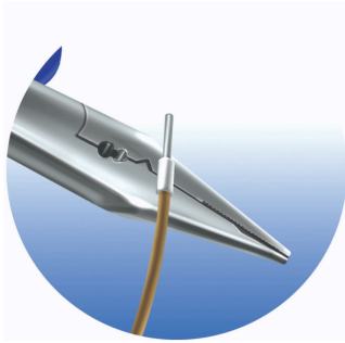
Stiskanje izoliranih igličastih kontaktov.
