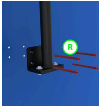
Namestiti stojalo na steno? Za montažo stojala na zid, pripravite luknje s svedrom velikosti 10mm in uporabite priložene stenske vložke in vijke (R).
