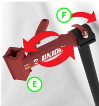
Ajuste el ángulo de las mordazas y sujete la bicicleta con seguridad? Para ajustar el ángulo de la mordaza del portabicicletas, suelte la palanca (F) y ajuste/gire (E).
