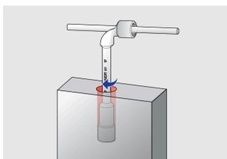
Grâce à son profil profond, la clé s'utilise également, sur écrous et filetages longs, comme une clé à douilles.
