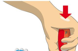
Surface maximale au contact de la main = puissance de couple accrue
