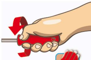
Surface de contact maximale pour une meilleure puissance de couple.
